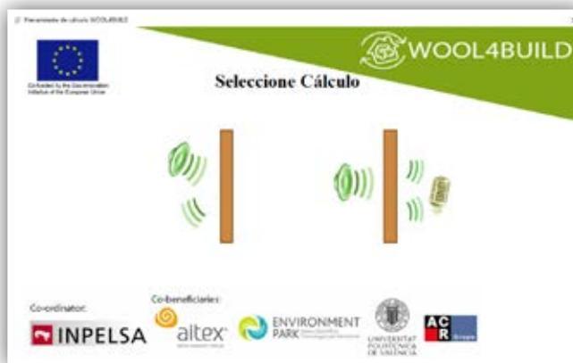
Figura 6. Pantalla de selección entre simulación de absorción (derecha) o aislamiento (izquierda).
