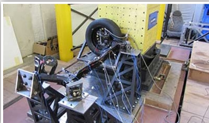
Figura 9. Imágenes del «CUBE» en ensayos experimentales de vehículos y componentes [17].
