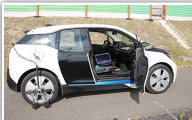
Figura 12. a) Sondas de intensidad sonora instaladas en la rueda [19]. b) Configuración OBSle instalada en un BMW i3 [19].
