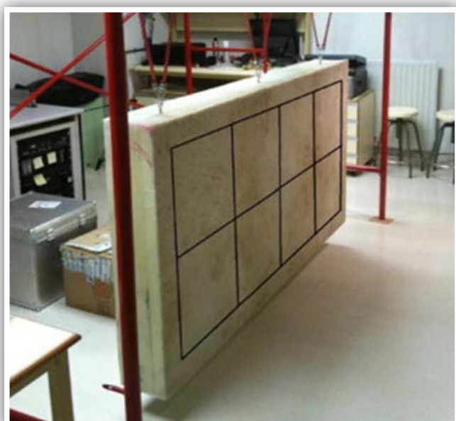
Figura 5. Muestra de material ligero dispuesto para su ensayo (condiciones de contorno y malla con los puntos de ensayo) [14].
