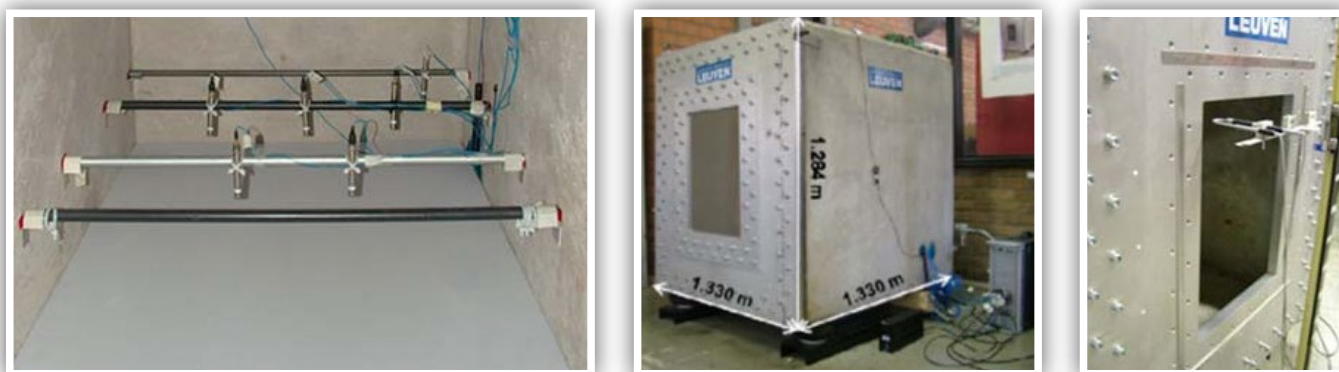
Figura 3. Cabina de ensayo para la caracterización vibro-acústica de materiales ligeros [12].
