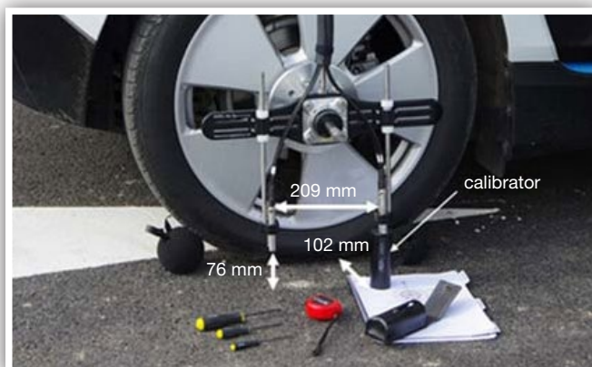
Figura 12. a) Sondas de intensidad sonora instaladas en la rueda [19]. b) Configuración OBSle instalada en un BMW i3 [19].
