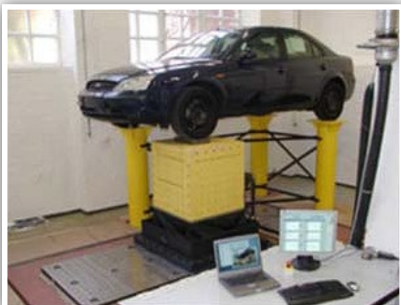
Figura 9. Imágenes del «CUBE» en ensayos experimentales de vehículos y componentes [17].
