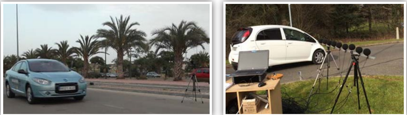
Figura 14. Ensayo pass-by y pass-by con array de sendos vehículos eléctricos [20][21].
