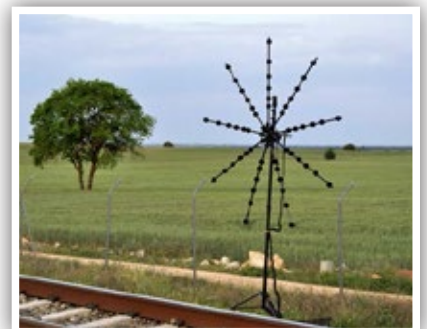
Micrófono array listo para tomar medidas.
