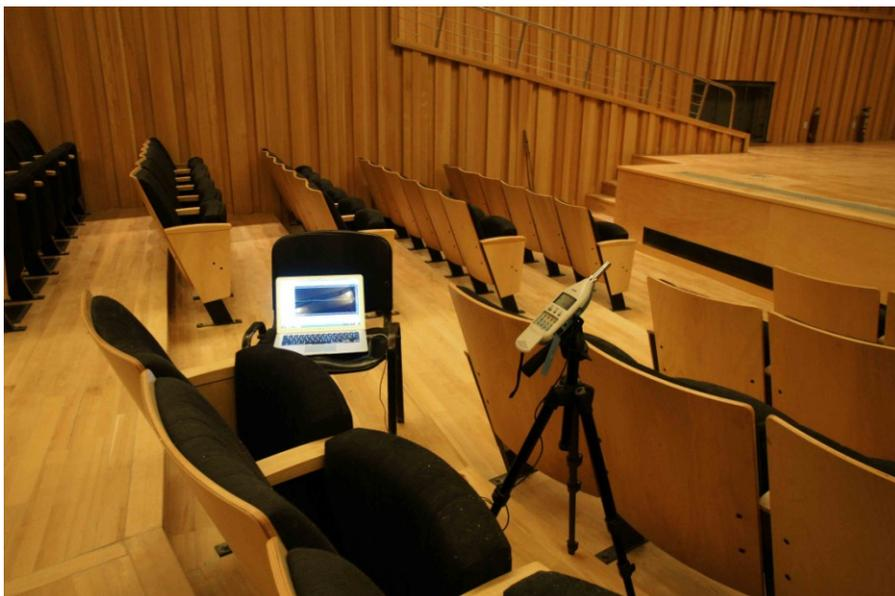
Fotografía 9: Medición de campo acústico en la Usina del Arte con las nuevas butacas instaladas
