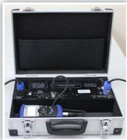
La fuente sonora ultraligera IAG DD5, ha sido ensayada junto con el amplificador de potencia ultraligero de 400 W, IAG DD400, de tan solo 3 Kg, conectado, a su vez, al generador de ruido rosa y blanco MR PRO.
