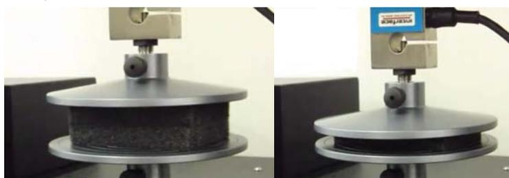
Figura 12 – Representação da realização do ensaio de deformação estática [7]
