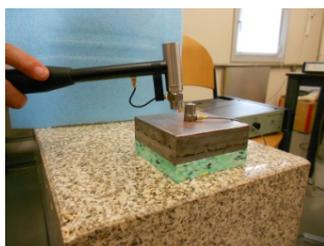
Figura 5 – Ensaio com a configuração de um grau de liberdade
