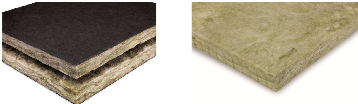
Figura 1. Lana mineral con revestimiento velo de vidrio y Lana mineral desnuda
