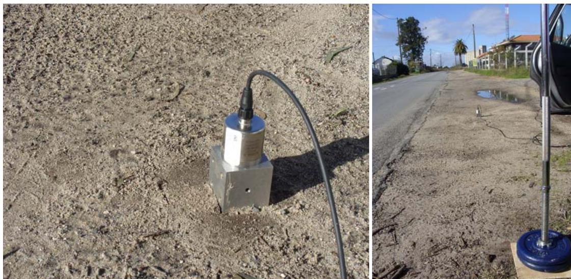
Figura 5 – Acelerómetro e massa de excitação para caracterização da propagação
