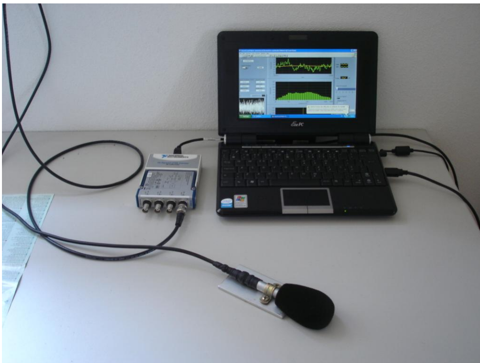
Figura 1 – Sistema de medição e aquisição de sinais sonoros – microfone, pré-amplificador, placa de aquisição e computador portátil.
