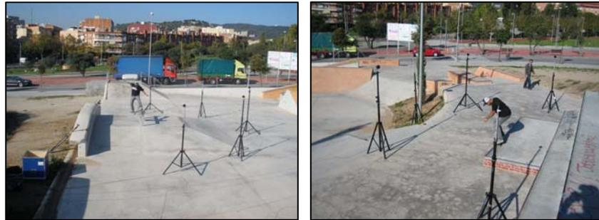
Figura 3 - Posición de los micrófonos respecto del elemento y del patinador.
