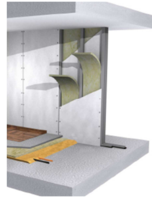
Figura 17 – Tabique de entramado autoportante
