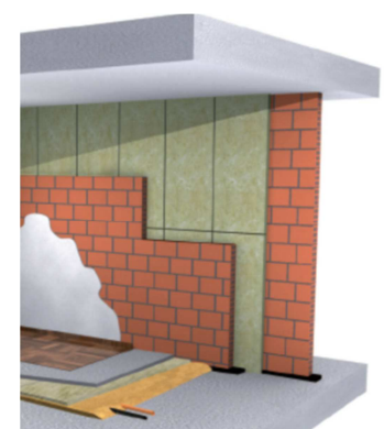
Figura 12 – Tabique de fábrica de ladrillo
