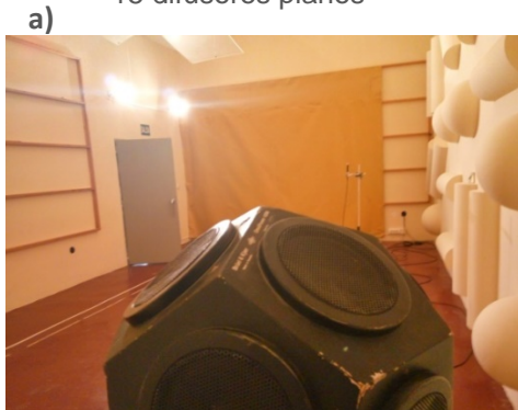
Figura 3. a) Disposición de los elementos para realización del ensayo en cámara reverberante; b) Esquema de la cámara reverberante utilizada.
