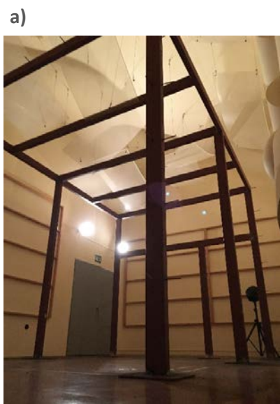
Figura 4. a) Estructura metálica del prototipo en cámara reverberante; b) Prototipo con muestra colocada.
