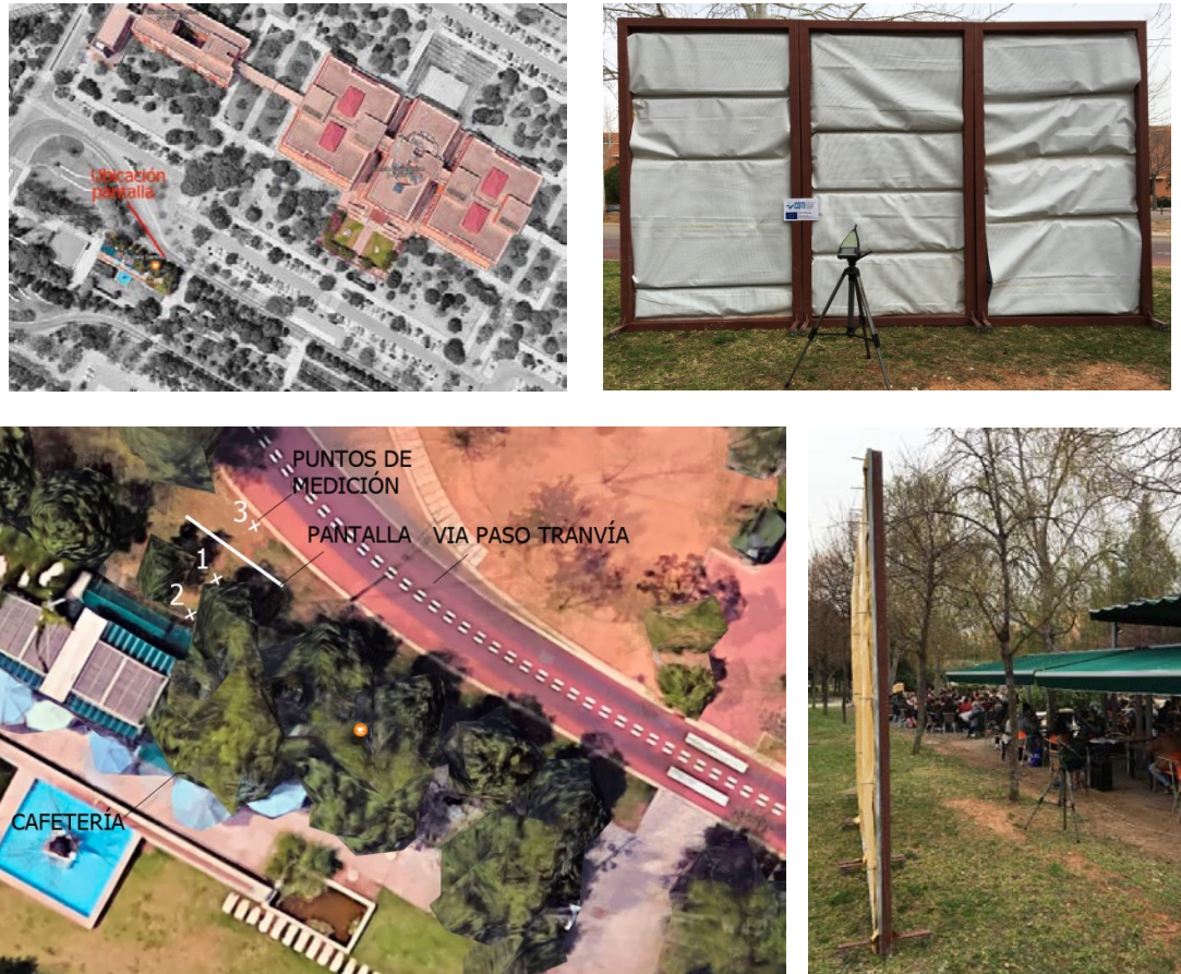
Figura 7. Disposición y procedimiento ensayo pantalla en la cafetería
