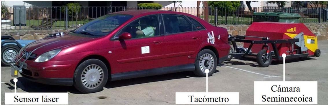
Fig. 3. Equipos empleados en la auscultación: Tiresonic MK4-LA<sup>2</sup>IC y LaserDynamicPG-LA2IC
