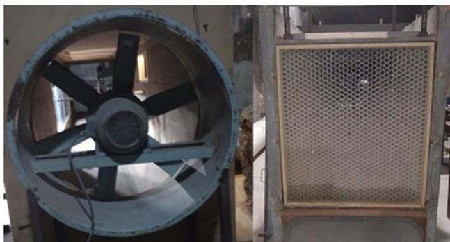
Figura 1. Ventilador (izquierda) y enderezador de flujo (derecha).
