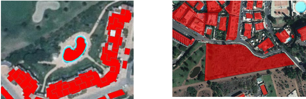
Fig. 5 – Recintos con altura que no se corresponden con edificios
