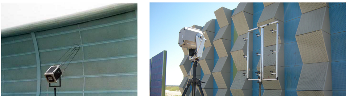
Figura 4 Antiguo método de medida de absorción/reflexión Adrienne (izquierda) y nuevo método Quesst (derecha)
