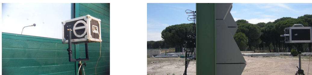
Figura 5 Antiguo método de medida de aislamiento Adrienne (izquierda) y nuevo método Quesst (derecha)
