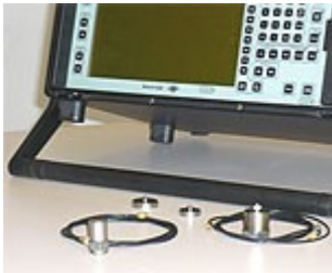
Analizador de espectros y acelerómetros de B&K para medición de vibraciones en edificios
