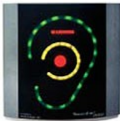
Sound Ear B&K VU 2509. Medidor de niveles sonoros en el interior. Sistema óptico graduable que constituye una herramienta ampliamente utilizada en educación ambiental
