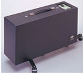
Máquina de impactos B&K 3207. Fuente normalizada generadora de ruido de impactos empleada en los ensayos de aislamiento a ruido de impacto
