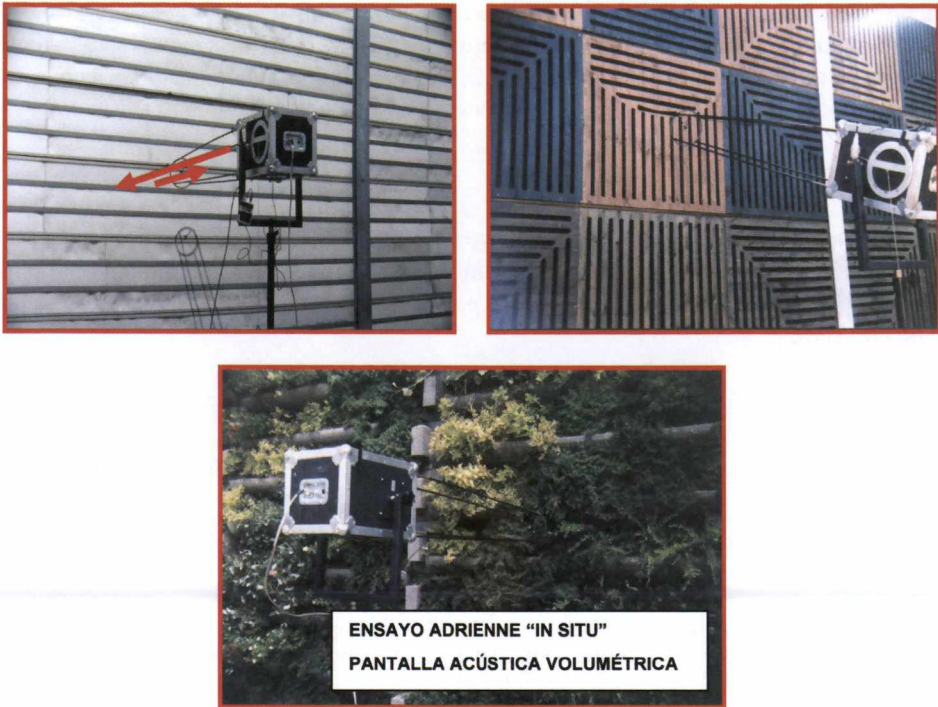
Figura 7.19. Ensayo ADRIENNE. TS 1793-5 Absorción sonora: Índice de reflexión DL_{RI}
