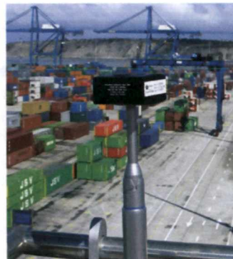
Figura 6.15. Verificación en campo de la calibración de un sonómetro y de un monitor semipermanente
