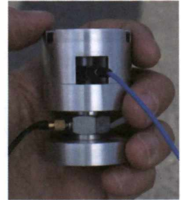
Figura 8.36. Método de medida de la impedancia mecánica “in situ” y detalle del útil de ensayo
