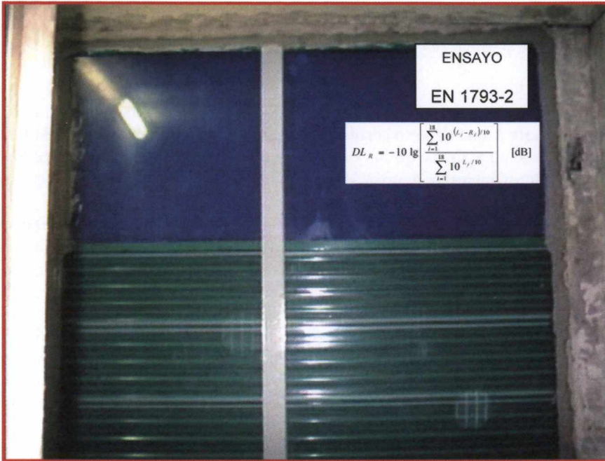
Figura 7.17. Ensayo del comportamiento aislante de un dispositivo reductor de ruido según EN 1793-2
