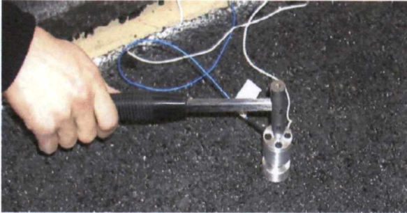
Figura 8.36. Método de medida de la impedancia mecánica “in situ” y detalle del útil de ensayo
