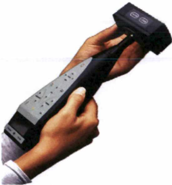
Figura 6.15. Verificación en campo de la calibración de un sonómetro y de un monitor semipermanente
