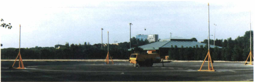
Figura 6.2. Instalación para la medida de potencia sonora según normas citadas
