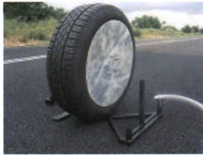
Figura 8.8. Ensayo realizado por la Fundación CIDAUT para evaluar el efecto de la impedancia acústica del terreno sobre el Horn effect
