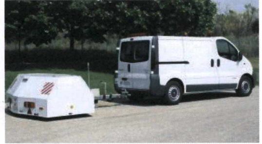
Figura 8.29. Ensayo CPX con trailer 8
