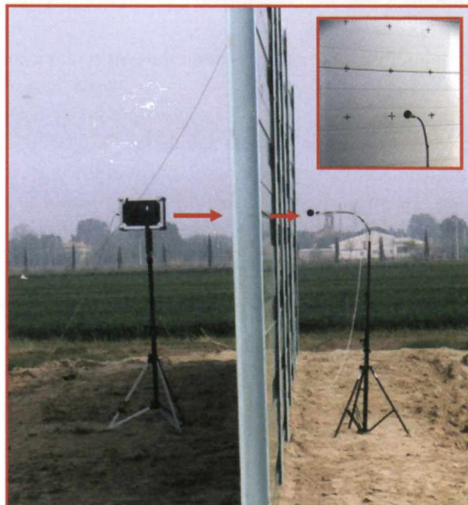
Figura 7.20. Ensayo ADRIENNE. TS 1793-6 Aislamiento acústico
