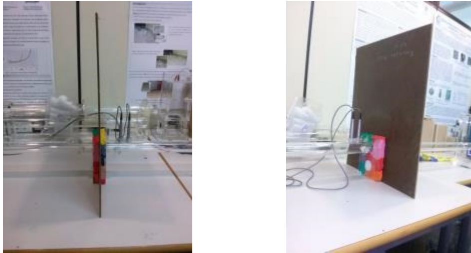
Figura 1. Detalles de ensayos del Green Composite utilizado en la solución de aislamiento a ruido aéreo. Ensayos de TL en incidencia normal. EPSG-UPV.
