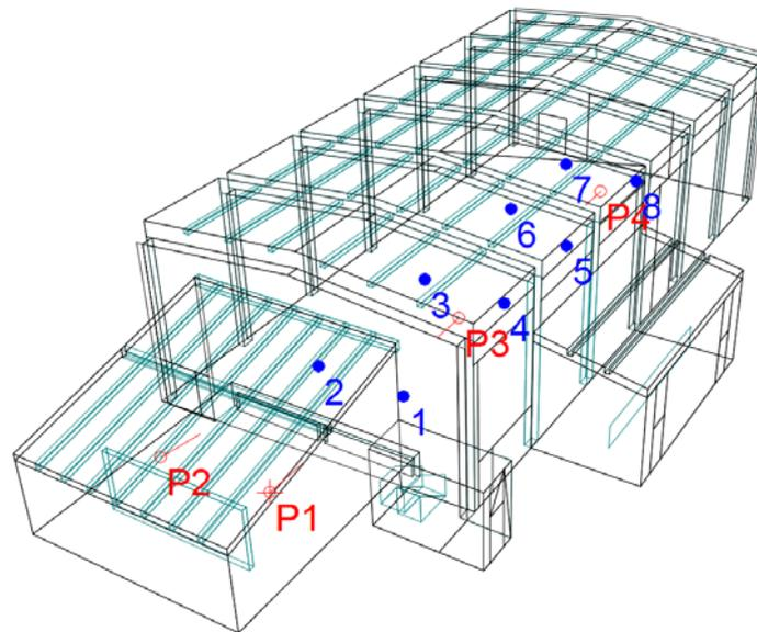
En las condiciones actuales podemos ver como el modelo arroja resultados acordes con la realidad (medidas in-situ realizadas), obteniéndose valores simulados de T30 entorno a los 5,1 s para frecuencias entre 500 y 1000 Hz. Valores del TR muy elevados para los criterios acústicos establecidos, pero coherente con la composición de sus elementos ya que todos son de carácter reflectante.
