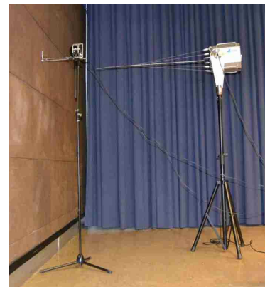
Figura 2. Sonda Zircon (derecha) y sonda de impedancia (izquierda).
