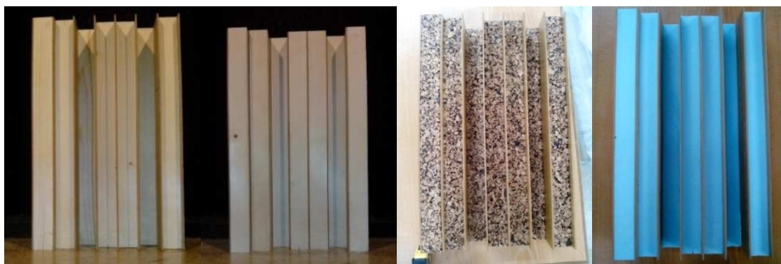
Figura 1: da esq a para a dir a , QRD em madeira maciça; sQRD em madeira maciça (sem guias-de-onda); QRD em aglomerado de cortiça e QRD em XPS
