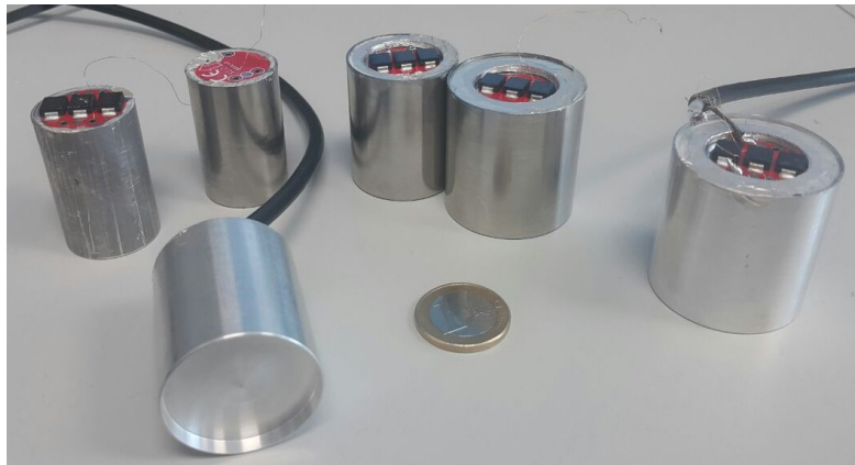
Figura 7. Diseños construidos de encapsulados tanto en aluminio como en acero
