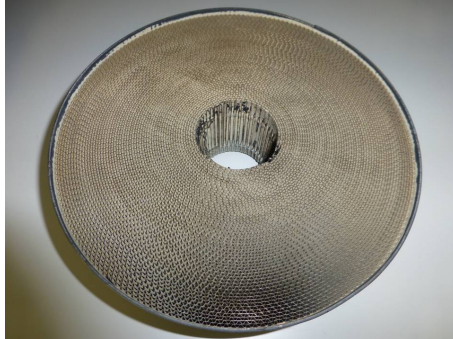
Figura 1 – (a) Prototipos de catalizador; (b) monolito cerámico de capilar cuadrado; (c) monolito metálico de capilar triangular; (d) esquema de catalizador, modelo 3D/1D (monolito reemplazado por una matriz de transferencia).
