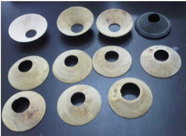
Fig. 1. Membranas de altoparlantes implementados con madera de café
