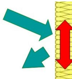
Para las lanas minerales, el coeficiente de absorción acústica depende fundamentalmente del espesor de los productos, y en menor medida de otros factores como pueden ser la densidad o el tipo de fibrado:
