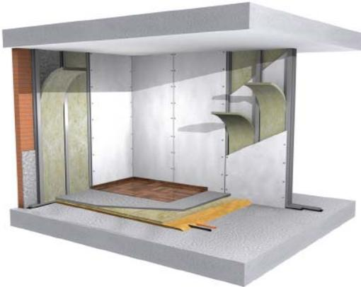
Sistemas formados por estructura de entramado autoportante rellena en su totalidad con lana mineral y placas de yeso laminado o placas de cemento reforzado.
