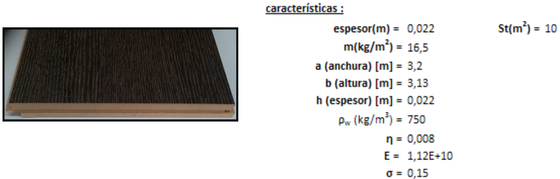
Figura 1. Izquierda: Fotografía de una de las estructuras tipo sandwich utilizadas. Derecha: Características técnicas del DMF
