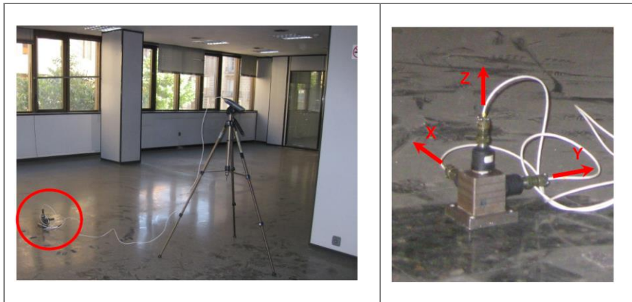
Figura 2. Detalle de uno de los puntos de medida de vibración antes de la remodelación del edificio.
