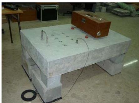
Figura 1 - Sistema de ensaio para determinação da redução sonora de revestimentos de piso de acordo com a ISO/CD 16251-1.
