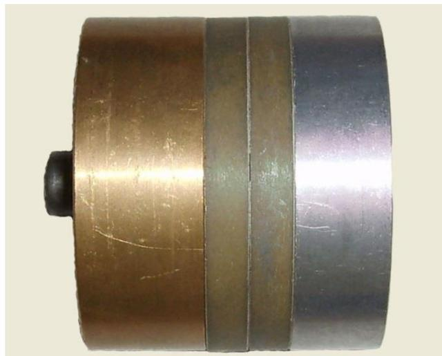
Figura 1. Transductor piezoeléctrico tipo Sándwich (Langevin) en el que se aprecian los dos elementos activos (en este caso PZT 8), la parte delantera de aluminio, la trasera de latón y la cabeza del tornillo de ajuste.
