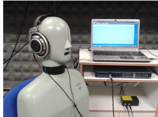
Figura 2. Montaje y maniquí para la medida de los auriculares
