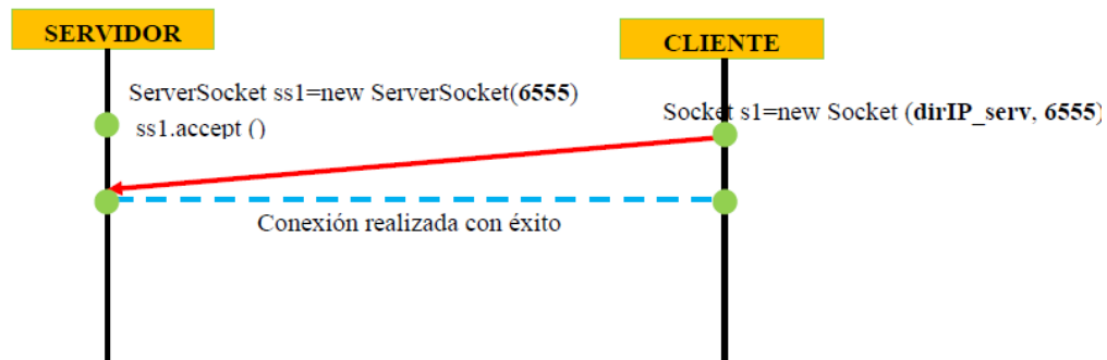
Fig. 2. Proceso de conexión cliente-servidor en Wi-Fi.
