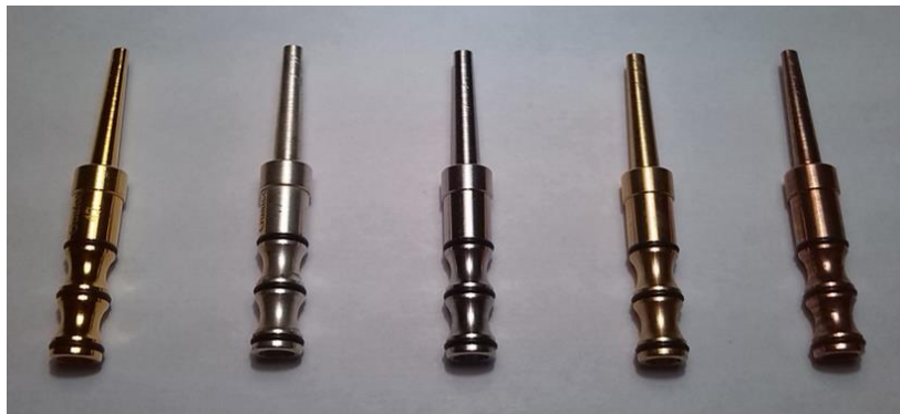
Figura 1: Tudeles con los distintos materiales: oro, plata, rodio, latón y cobre (ordenados de izquierda a derecha).
