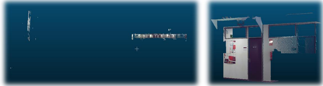
Fig. 1. Resultado total del escaneo, a la izquierda incluye ruido, a la derecha extracto de la nube.
