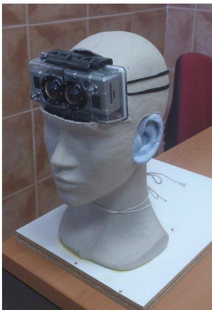
Figura 2. Maniquí fabricado para captación de video y audio.
