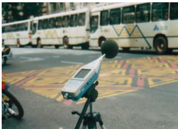
Foto1: Sonômetro utilizado na medição do ruído do mapa de ruído de Belém
