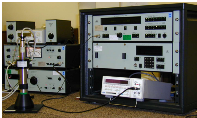
Figura 5 – Método de aplicação de tensão para a calibração de pistãofones
