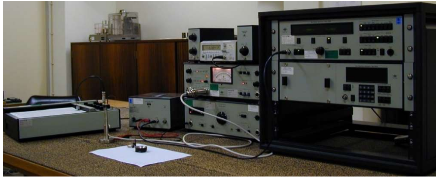
Figura 3 –Instrumentação utilizada na determinação da característica de resposta em frequência de microfones de condensador
