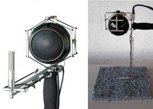
Figura 3. Equipo de medición de absorción acústica in situ basada en sonda PU
