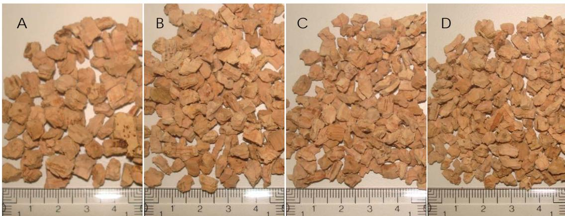
**Figura 1.** Detalle de los diferentes granos de corcho empleados para tamaños: (A) mayores de 6.3 mm, (B) de 5.6 a 6.3 mm, (C) de 5.0 a 5.6 mm y (D) de 4.0 y 5.0 mm.
