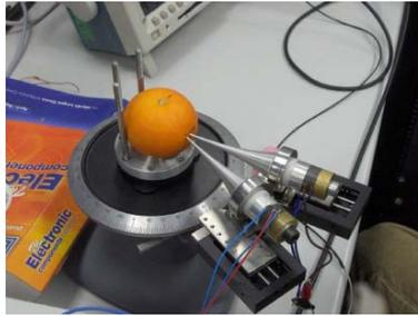
Fig. 1. Dispositivo experimental usado para la caracterización de cítricos.
