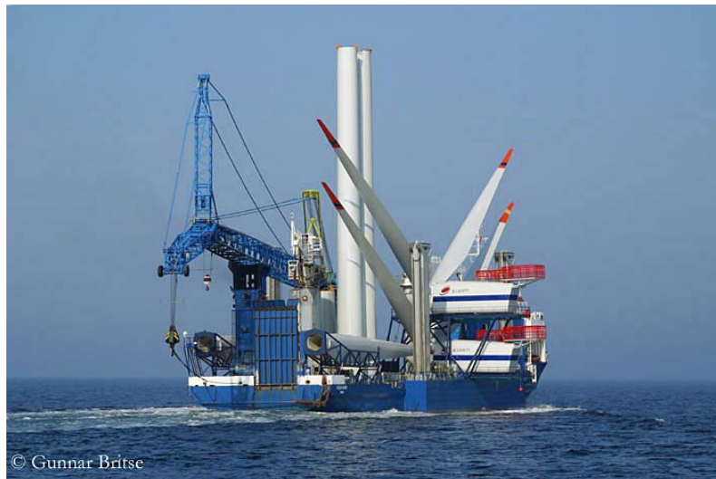
Figura 10. Infraestructura de transporte y clavado de pilotes en un Parque Offshore.
