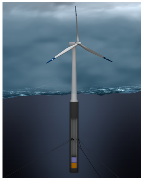
Figura 3. Solución flotante de aerogenerador offshore
