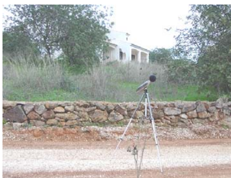
Figura 7 - Sonómetro em plena medição junto de um receptor sensível
