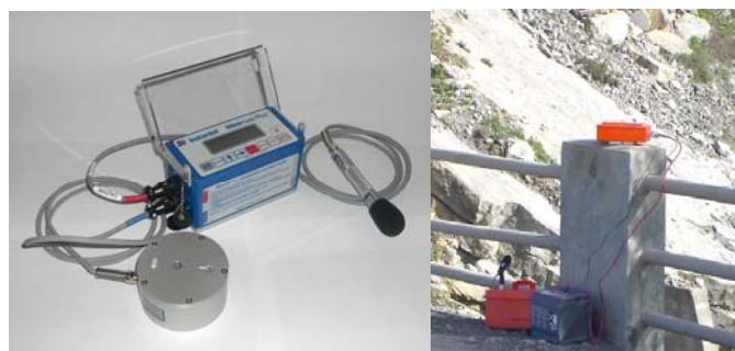
Figura 2 - Sismógrafo com transdutor triaxial e microfone
