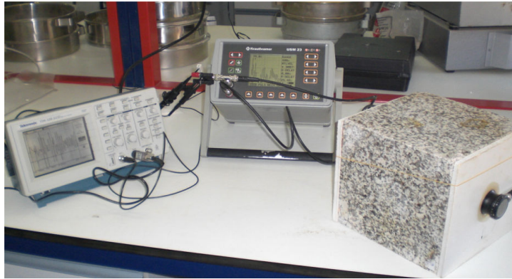
Figura 1- Dispositivo experimental para la medida del tiempo de vuelo de onda transversal
