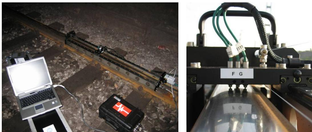
Figura 6. Vista del equipamiento utilizado para la medida de la rugosidad del carril.
