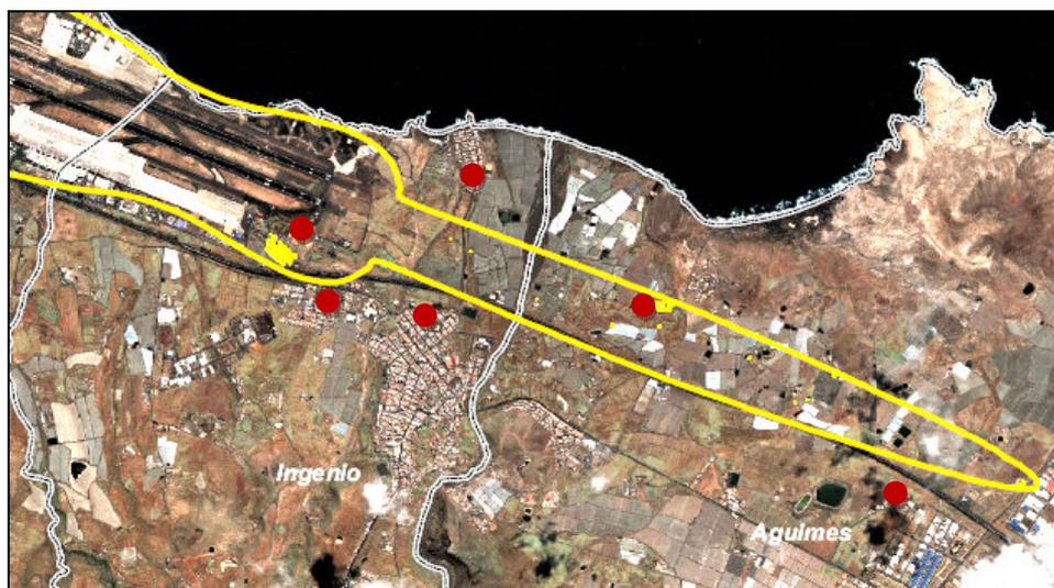
Figura 1 – Situación de las estaciones de medidas y la isófona  $L_{AeqN} 55$  dBA del plan de aislamiento acústico.
