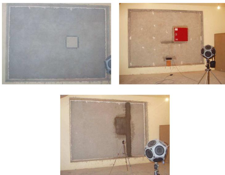
Figura 8– Parede de alvenaria na presença das várias inclusões, quadro eléctrico, carretel de incêndio e tubo de queda.
