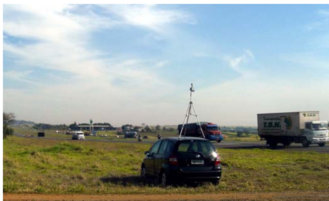
Figura 2 – Foto da medição sonora executada a 25m do centro da rodovia.
