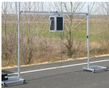
Figura 8– Medida de la absorción acústica de un pavimento poroso ISO 13472-1: 2002.
