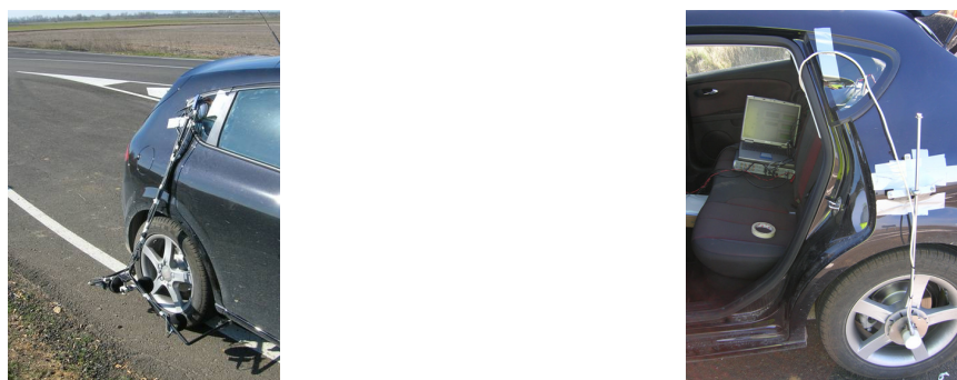
Figura 2– Montaje de ensayo para la medida del ruido de rodadura en carretera mediante el método de proximidad CPX.
