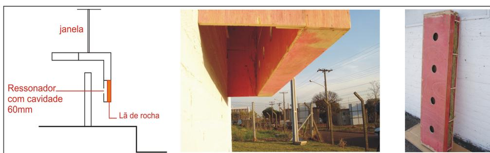
Figura 9 – Configuração 08: Janela com peitoril ventilado – Ressonadores e material absorvedor na parte inferior da superfície interna do canal do peitoril ventilado.
